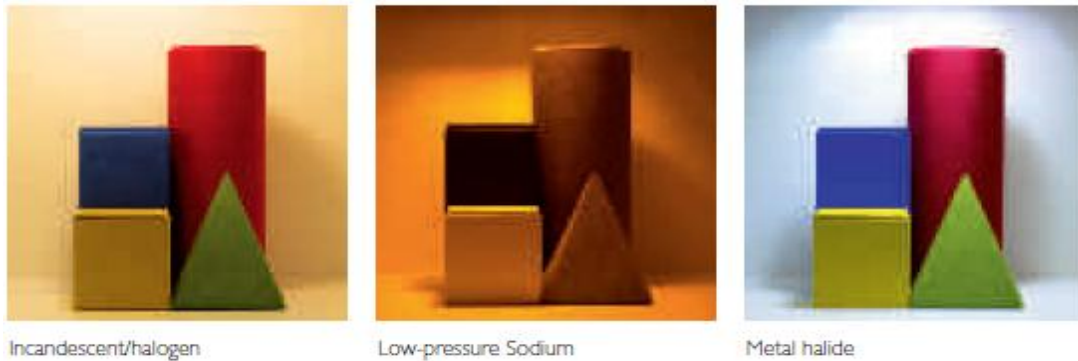
شكل (2-7) الأداء اللوني لبعض مصادر الإضاءة الصناعية (Philips,2008)
